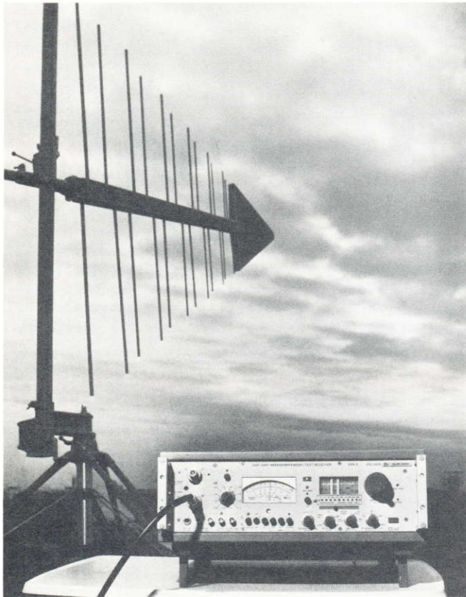
BILD 2 VHF-UHF-Feldstärkemeßgerät HFU 2 mit der logarithmisch-periodischen Breitbandantenne HL 023 für 80 bis 1300 MHz. Foto 24 460/5
