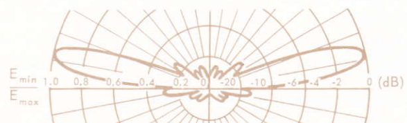
Bild 8 Beispiel eines angehobenen und nullstellenaufgefüllten Vertikaldiagrammes der UHF-Rundstrahlantenne HA 165/47./50
