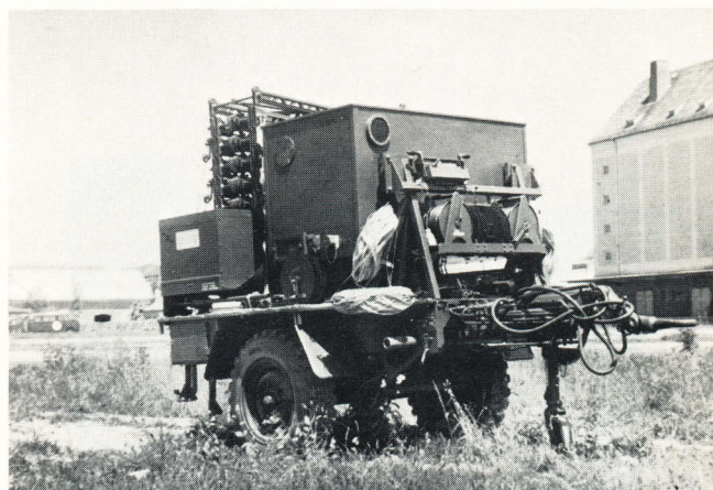
BILD 1 Antennenanlage NK 20/3909 mit eingefahrener Antenne auf dem Zweiradanhänger. Foto 21 662/1
