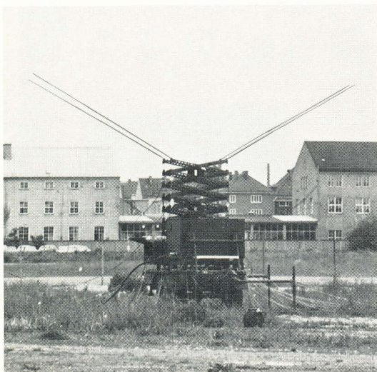
BILD 2 Ausfahren der Scherenantenne HA 47/46.
